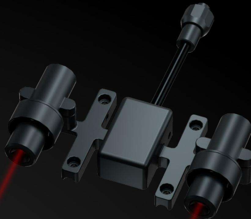
**CHASING雷射卡尺**是為CHASING M2 S、M2 PRO ROV訂製開發的專屬配件，10CM間距紅色雷射光束，使用簡單，主要用於對水產養殖生物尺寸、船舶和水庫裂縫長度的測量估算。廣泛應用於水產養殖、水庫巡檢、船舶檢修等領域。
